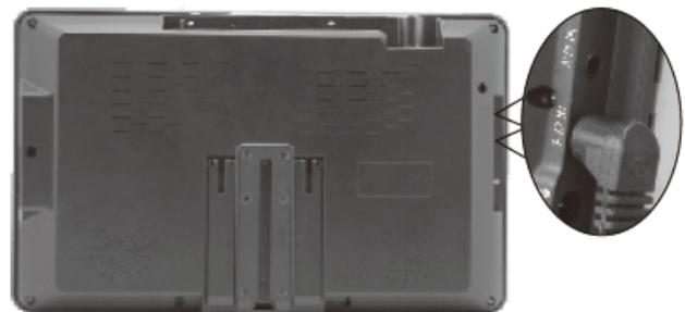
Insertar el conector delgado del cable de conversión de Audio/Video al conector de entrada de Audio/Video "AV IN" o de salida de Audio/Video "AV OUT".
