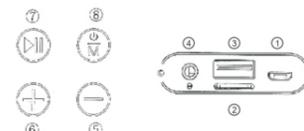
1. Conector de carga micro USB: Conectar el cable de carga USB para cargar la batería.
