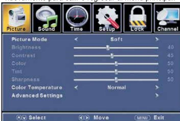
Presionar "▼ o ▲" para seleccionar entre las opciones de Modo de imagen, Brillo, Contraste, Color, Tinta, Nitidez, Temperatura de Color y Ajustes avanzados.
