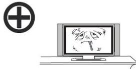
El TV LED debe ubicarse lejos de altas temperaturas, fuentes de calor o luz directa del sol. Este requiere buena ventilación. Deje por lo menos 10 cm entre el TV LED y otros aparatos o armarios. Cuando
