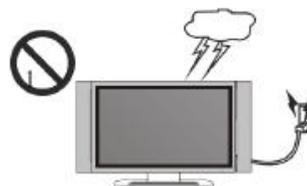
No quite la cubierta trasera. Dentro de la unidad hay alto voltaje que puede ocasionar golpes eléctricos. Ajustes internos y verificaciones deben ser realizados sólo por calificados profesionales.
