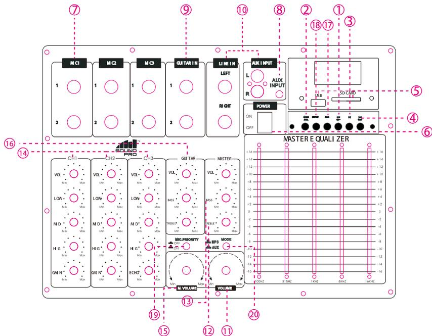
1. **⏪/CH-**: En el modo de USB, SD o Bluetooth, presionar para saltar a la pista anterior, presionar y sostener para disminuir el nivel de volumen. En el modo de Radio FM, presionar para sintonizar la estación anterior, presionar y sostener para disminuir el nivel de volumen.
